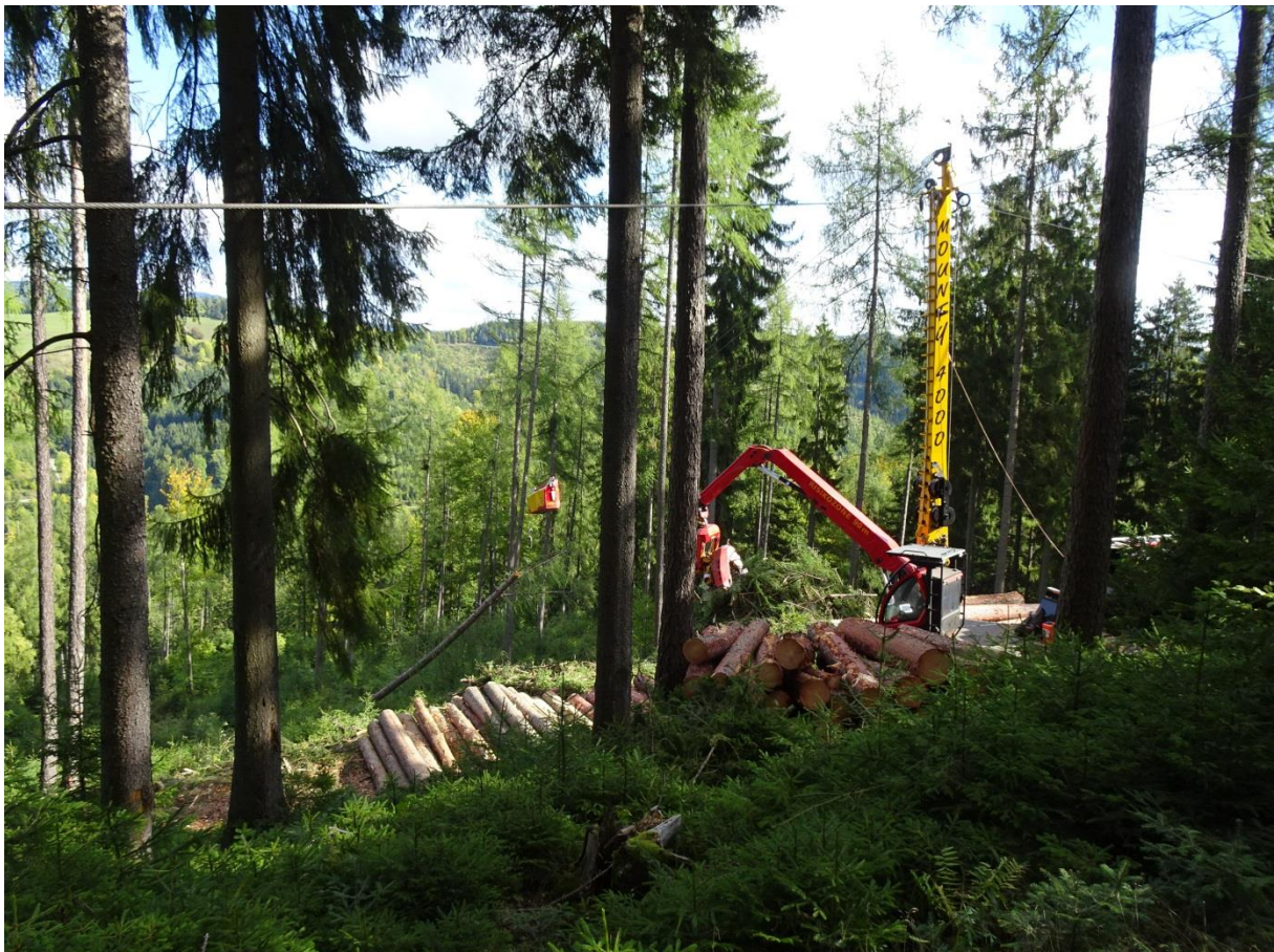
Abbildung 1: Seilgeräte in Kombination mit Kran und Prozessor - die leistungsfähigste Holzernte-Technologie für gebirgige Regionen ist in Österreich sehr oft im Einsatz.
