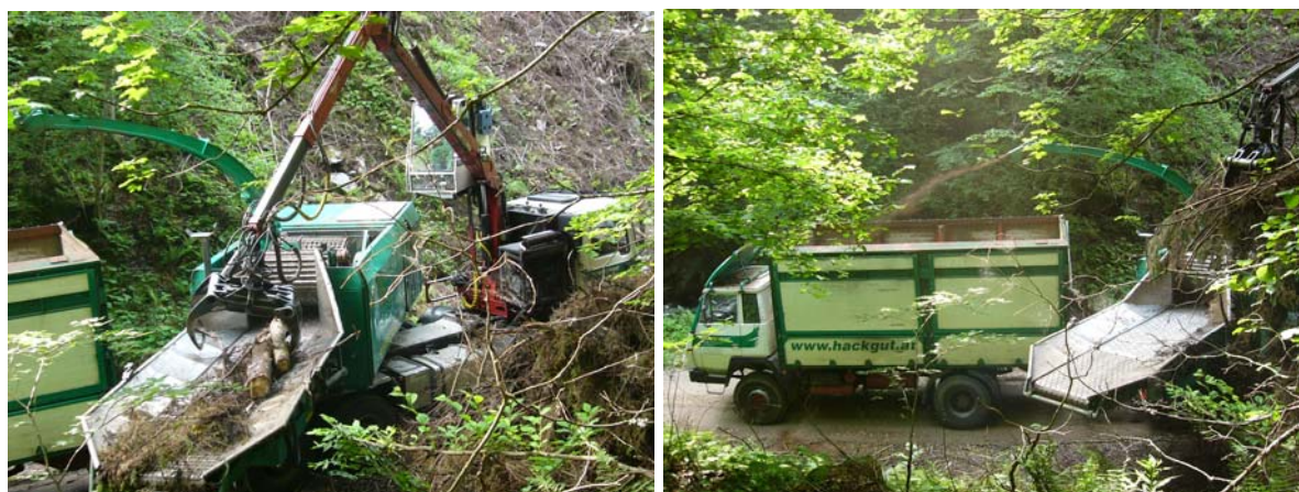
Abbildung 4: Der Trommelhacker Jenz HEM 35 D hackt in 33 m 3 Schüttgut-Lkw
