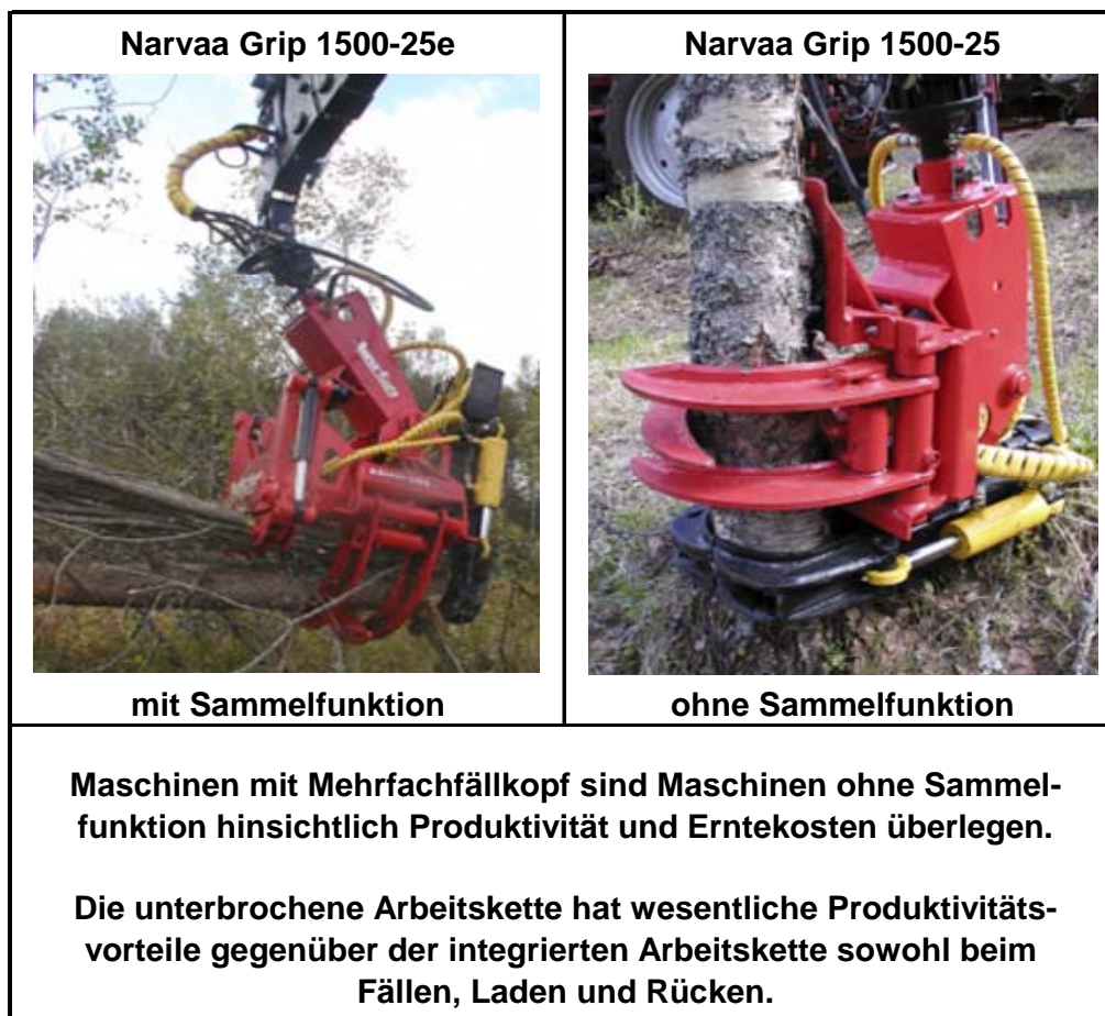
Abbildung 14: Mehrfachfällkopf und Einfachfällkopf im Vergleich. Bilder ( www.pentinpaja.fi )
