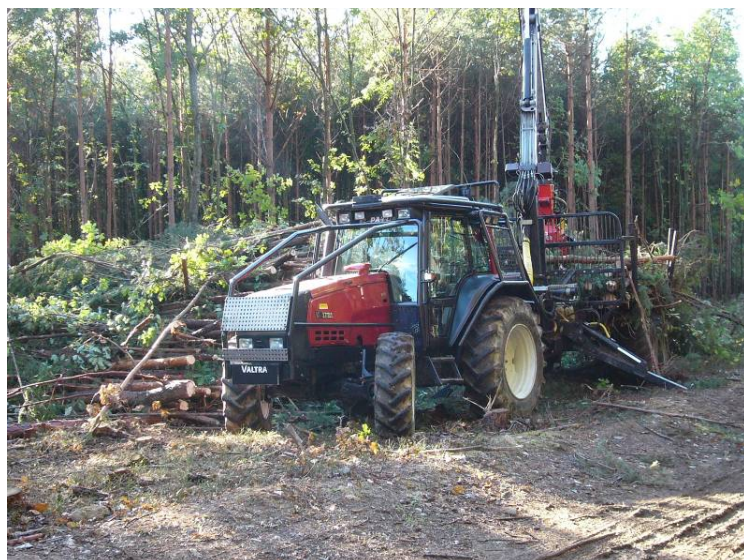
Abbildung 3: Maschinenkombination für die Energieholzernte beim Entladen
