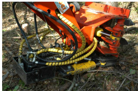
Abbildung 1: Fällaggregat Naarva Grip 1500-25 (ohne Sammelfunktion)
