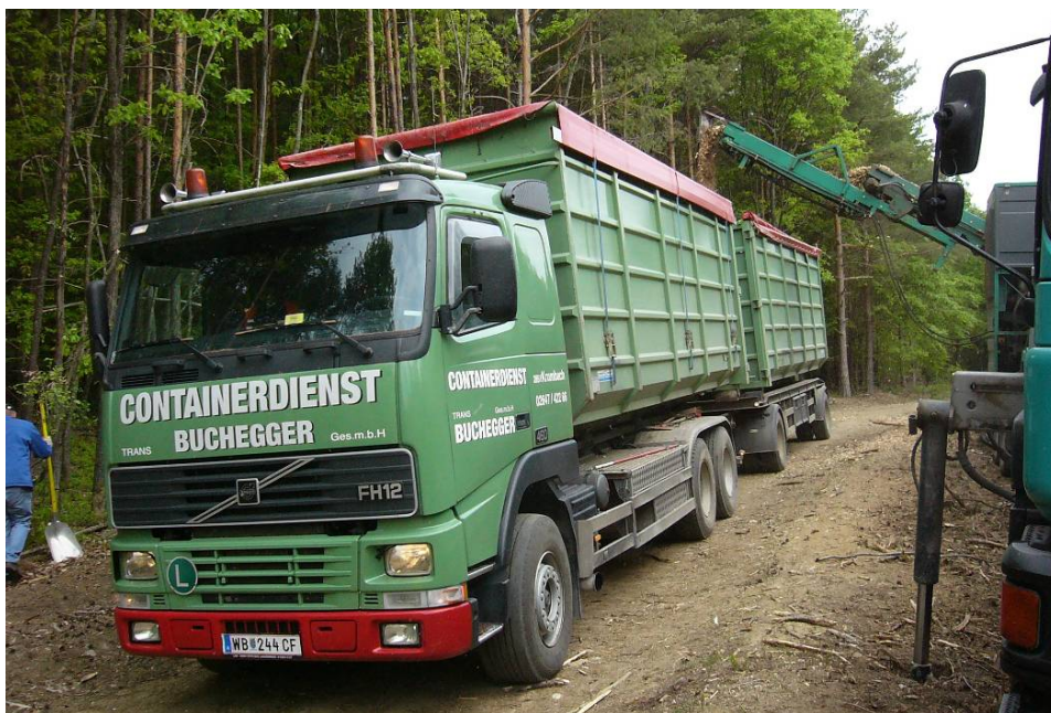
Abbildung 5: Lkw-Zug mit Abrollcontainern zu je 38 m 3 Ladekapazität
