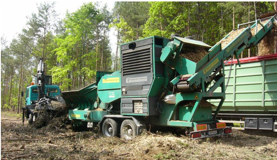
Abbildung 4: Hacker Rudnick & Enners beschickt durch einen auf MAN Lkw aufgebauten Kran
