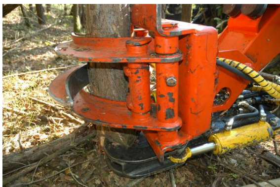
Abbildung 1: Fällaggregat Naarva Grip 1500-25 (ohne Sammelfunktion)
