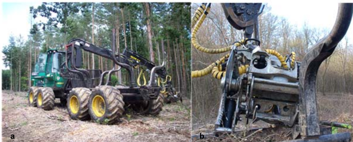
Abbildung 2: Timberjack 1110 D Forwarder (a) mit Moipu 400E Fäller-Sammler-Aggregat (b)
