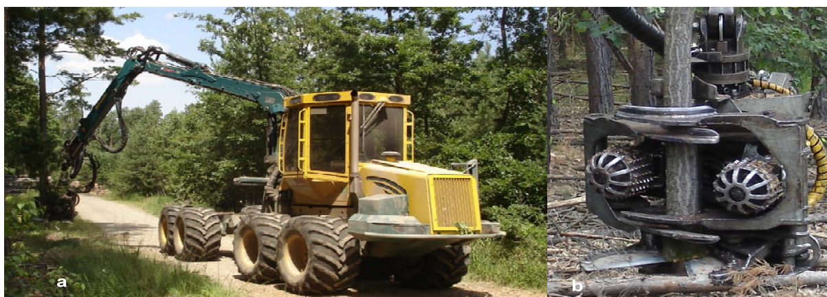
Abbildung 1: HSM 208 f Forwarder (a) mit Moipu 300ES Fällern-Sammler-Aggregat (b)
