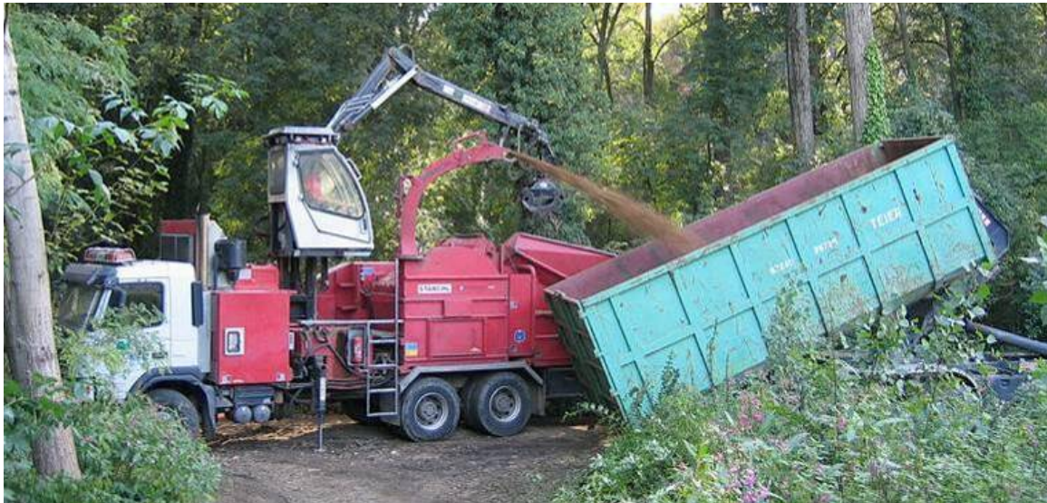
Abbildung 20: Vereinfachte Direktbeladung bei Wechselcontainer durch die Möglichkeit des Aufklappens und Absetzens.
