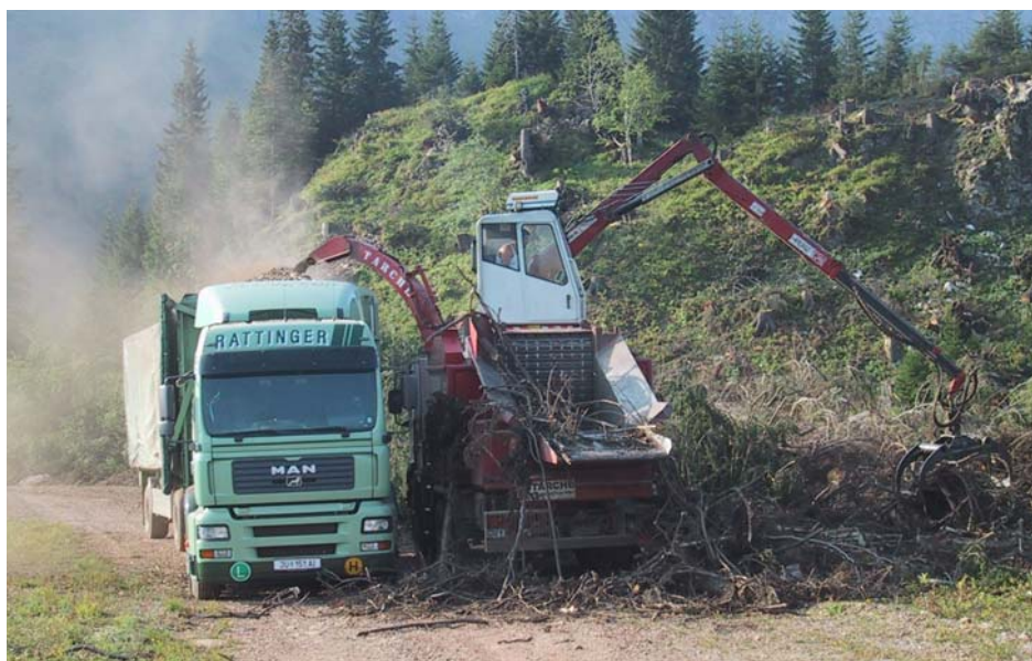
Abbildung 7: Hacken von Schlagrücklass - Nadelholz mit Direktbeladung auf Schüttgut-Lkw.
