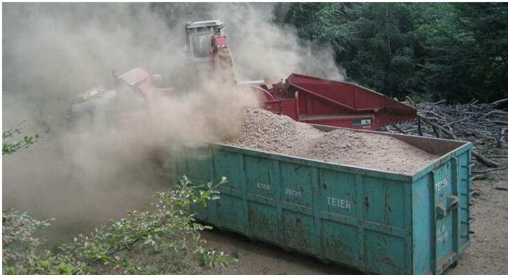
Abbildung 19: Hohe Staubentwicklung beim Hacken von Laubholz mit geringem Wassergehalt.
