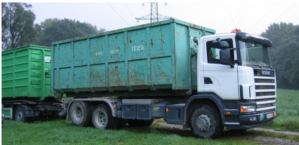
Abbildung 5: Lkw-Zug mit Abrollcontainern zu je 36 m 3 Fassungsvermögen.
