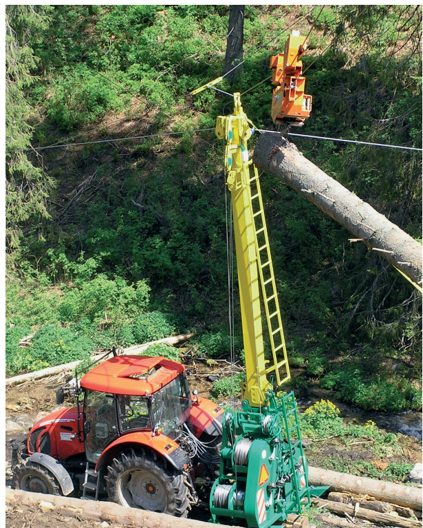
> Mastseilgerät Larix Lamako mit Laufwagen MM-Sherpa U 3 t, max. Arbeitsdistanz 500 m
