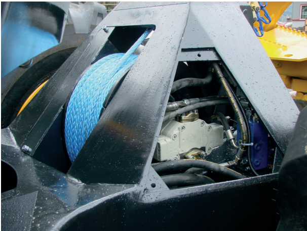
> Hilfs- und Rückeseilwinde im Highlander, Hersteller Konrad Forsttechnik GmbH, Preitenegg
