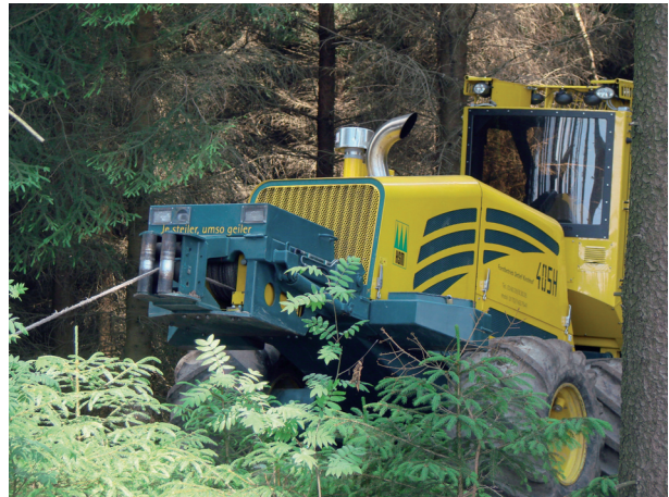
> Traktionshilfswinde Adler EHY 16 S 3 an dem Harvester HSM 405 H2 8WD, Hersteller Adler GmbH, Wolfegg
