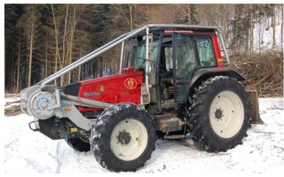
**Abbildung 1:** Traktor mit Frontlader und Rückezange (links); Traktor mit Frontwinde (rechts).
