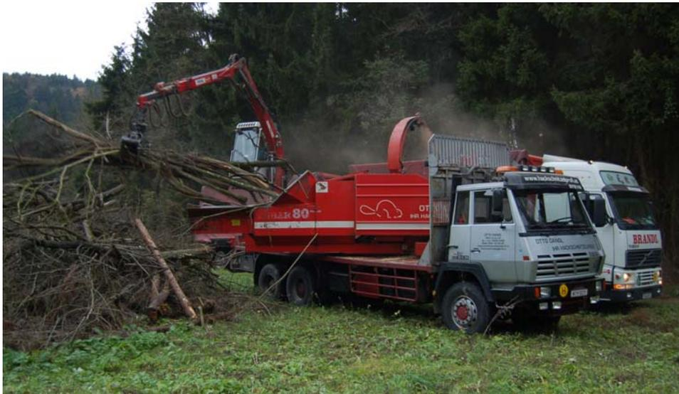
**Abbildung 3:** Hacker Eschlböck Biber 80 aufgebaut auf Steyr 32S34 6x6.
