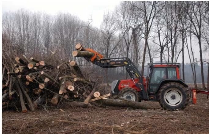
**Abbildung 14:** Traktor beim Poltern von Energieholz.
