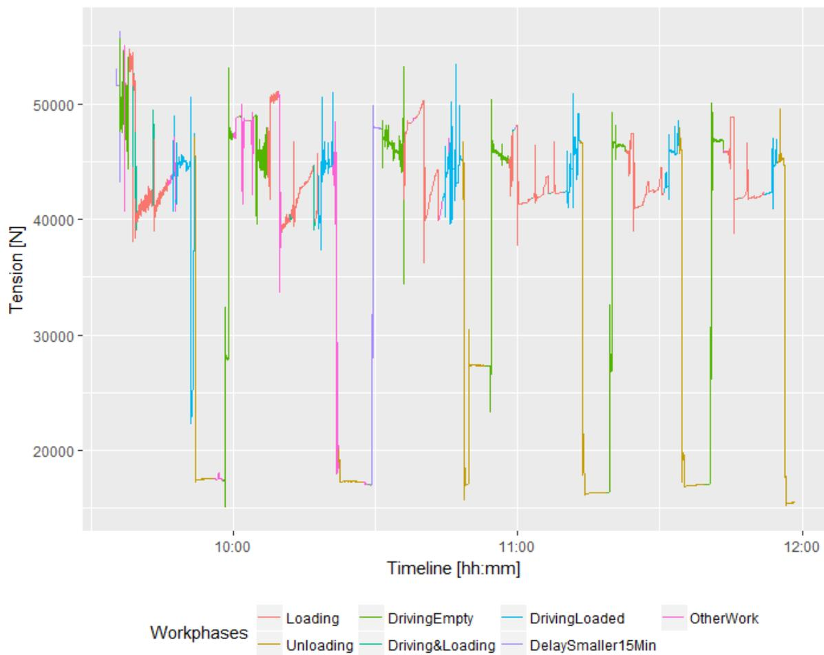
Abbildung 3: Typischer Seilspannungsverlauf bei der Arbeit mit dem Forwarder
