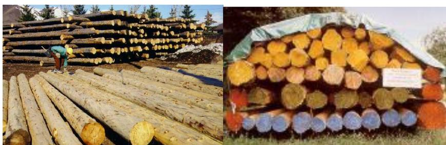
Abbildung 24: Bilder von verschiedenen Kreuzpoltern für die Bauholztrocknung.
