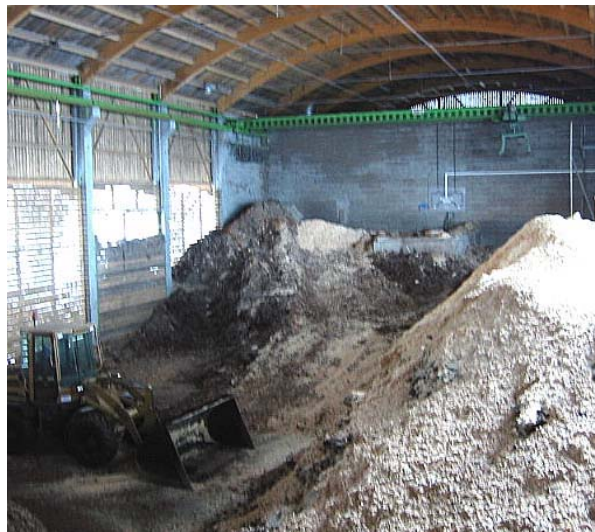
Abbildung 40: Brennstofflager eines großen Biomasseheizwerkes in Österreich mit einem Brennstoffmix aus unterschiedlichsten Energieholzsortimenten. Bei großen Kesselanlagen werden von den Kesselherstellern Brennstoffe mit einem Wassergehalt zwischen 10 % bis 60 (65) % zugelassen. Die Heizwerkbetreiber mischen die unterschiedlichen Brennstoffe in der Regel nach den eigenen Erfahrungswerten für den störungsfreien Anlagenbetrieb ab. (Bild: E.V.A. – the Austrian Energy Agency)
