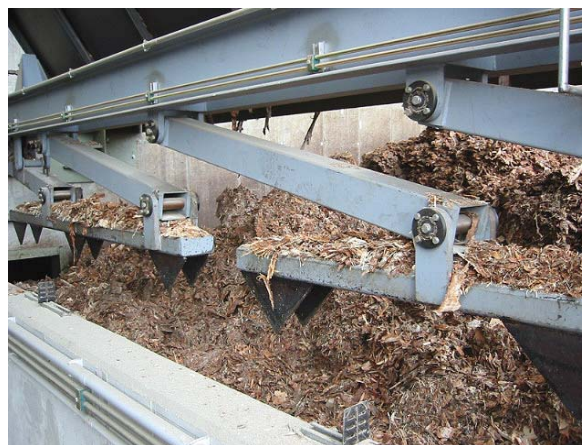
Abbildung 41: Die Stückigkeit des Brennstoffes kann (z.Bsp. Brückenbildung bei Rinde) auch bei größeren Anlagen zu Problemen bei der Brennstoffbeschickung führen. (Bild: E.V.A. – the Austrian Energy Agency)
