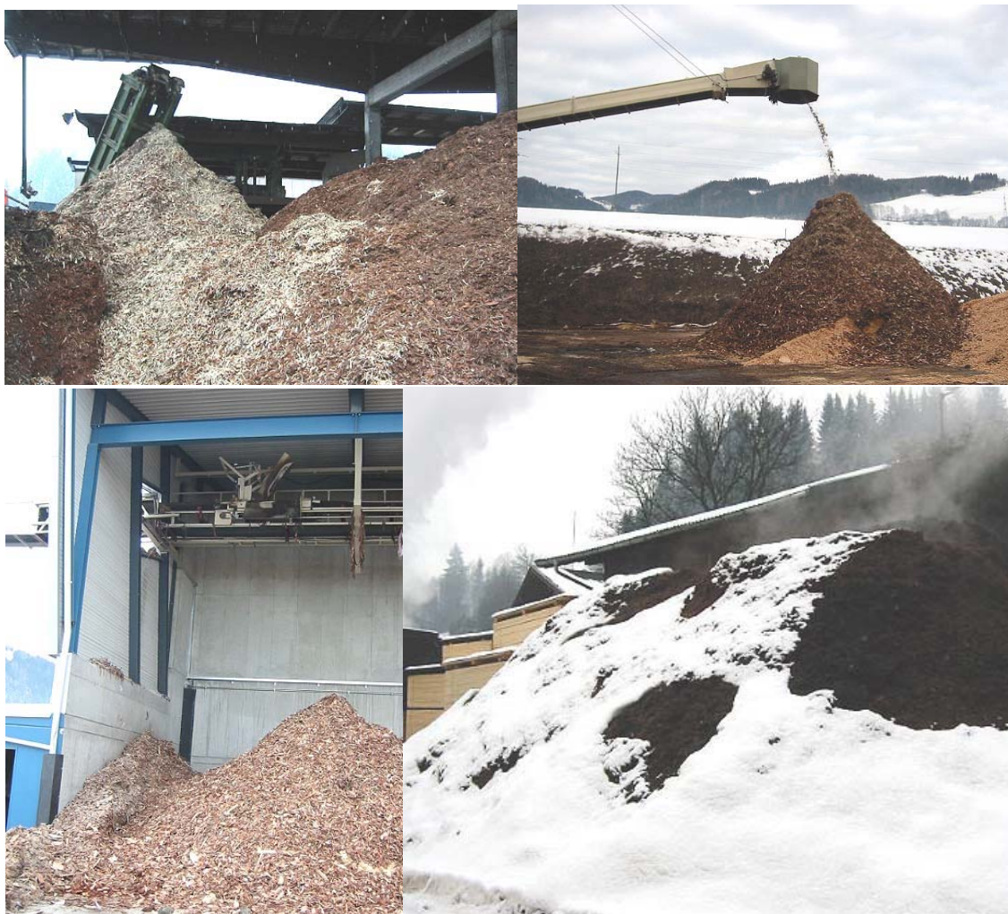
Abbildung 28: Restholzabwurf direkt aus dem Produktionsprozess bei den Energiezentralen bzw. auf dem Zwischenlagerplatz in Sägewerksbetrieben. In der Regel wird die anfallende Restholzmenge nur nach Prozentsätzen der Einschnittmengen abgeschätzt. (Bild: E.V.A. – the Austrian Energy Agency)
