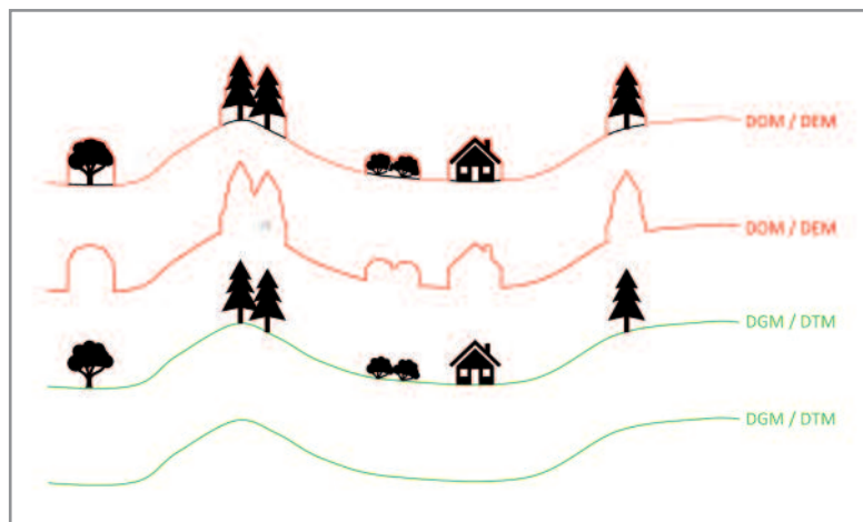
> Abbildung 5: Bildliche Darstellung der Definition von digitalen Höhenmodellen (DHM). In Rot dargestellt ist das Digitale Oberflächenmodell (DOM, englisch digital elevation model (DEM)). In Grün dargestellt ist das Digitale Geländemodell (DGM, englisch digital terrain model (DTM)).
