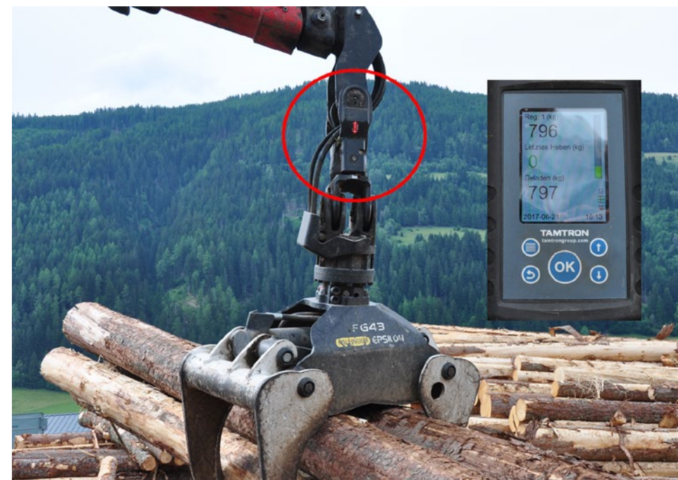
Die eingebaute Waage stört den Arbeitsablauf nicht. Die Anzeige erfolgt am übersichtlichen Display.
