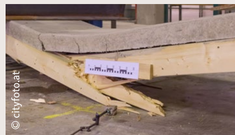
Bei einer Belastung von 14 Tonnen verabschiedeten sich die vorbereiteten Holz-Beton-Verbund-Elemente. Das entspricht dem Gewicht von einem 50-Sitzer-Reisebus.
