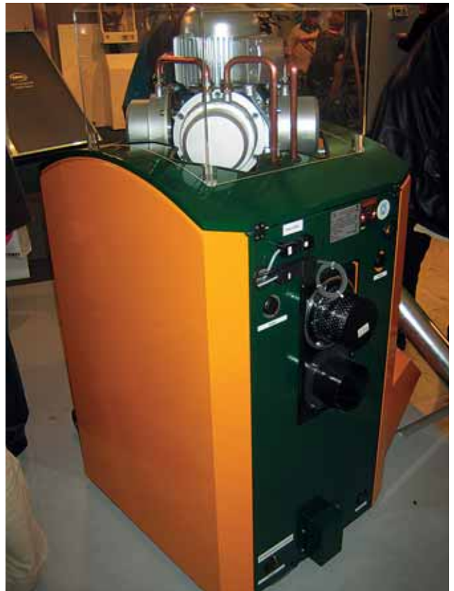
> Pelletsbefeuerter SPM-Stirlingmotor, 1 kW el, evtl. ab 2008 am Markt. ([9])
