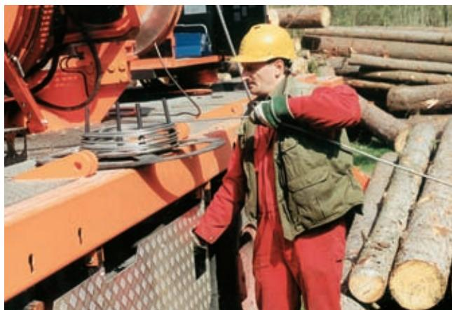
a) Na ploče koje se pokreću hidraulično utaknu se okomito klinovi. Namotana i povezana užad može se skinuti nakon što se izvuku klinovi.
