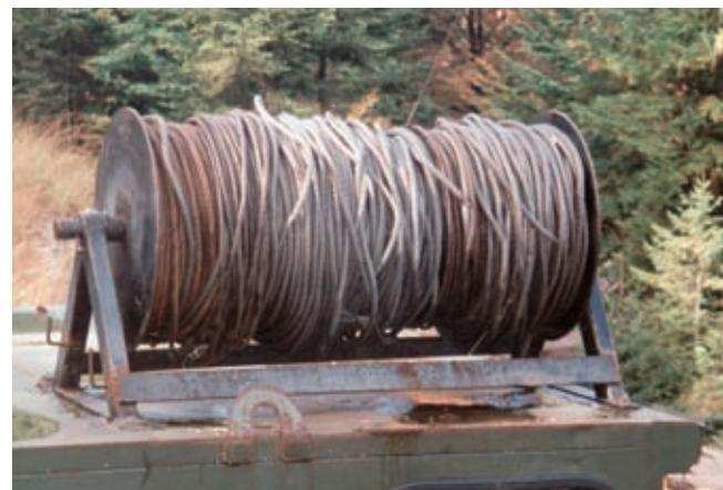
b) Na hidraulično vratilo su montirani pretinci s mogućnošću učvršćivanja krajeva užadi. Užad se namotava preko kotura na bubenj. Vjenac se ne može skinuti već se pospremi u bubenj. Kod slijedećeg korištenja uže se vuče iz bubenja.
