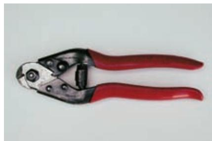
> Kabelske škare C 7 za odvajanje spletica/strukova (oprema za upletanje užeta)
