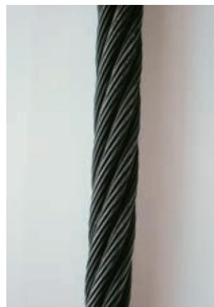
> Uže istosmjernog namatanja desni namotaj
