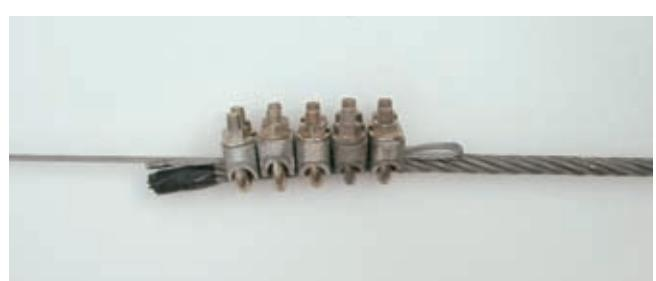
**(Povezivanje vučnog i nosivog užeta pletenjem/upletom za visoke zahtjeve - terete)**
