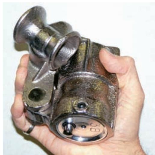
U svrhu racionalizacije radilo se na razvoju automatike za odvezivanje tereta. Na taj način se olakšava i skraćuje rad na odvezivanju/otkvačivanju tereta na stovarištu. Zbog visoke vlastite težine (oko 5 daN) upotrebljava se za sada samo kod stablovne metode i kod iznošenja oblovine.
