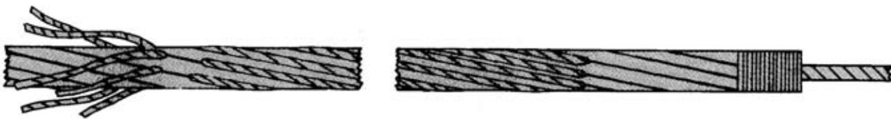
> Spoj vučnog i nosivog užeta
