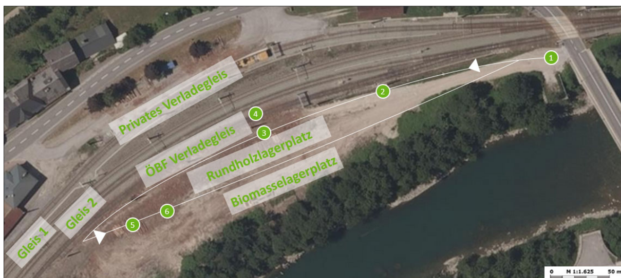
Abbildung 6: Betriebsablauf am Terminal: (1) Einfahrt Terminal, (2) Ladung entsichern, (3) Waggon beladen, (4) Waggonladung sichern, (5) LKW-Ladefläche reinigen, (6) Lieferschein ausfüllen.
